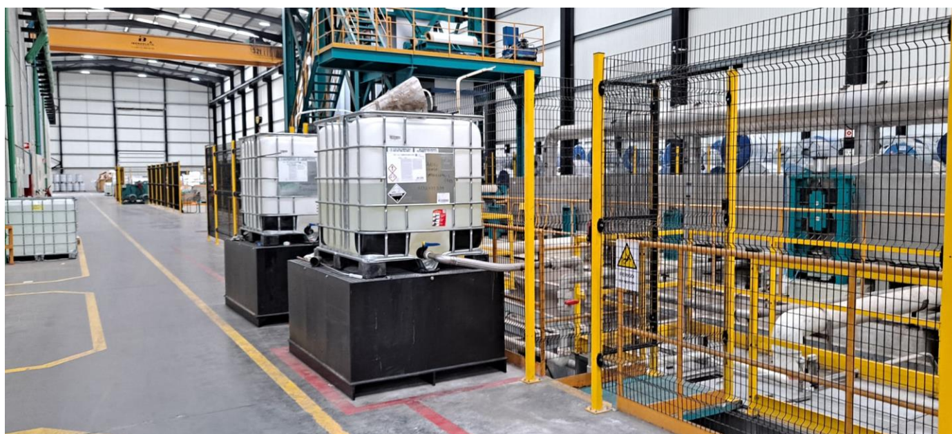
Figura 85: Produtos químicos em bacias de retenção individualizadas junto à linha de produção.
